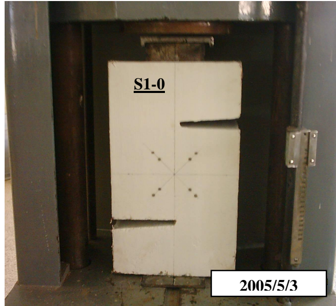
الشكل(5): نموذج فحص القص (S1-0) داخل جهاز الفحص
